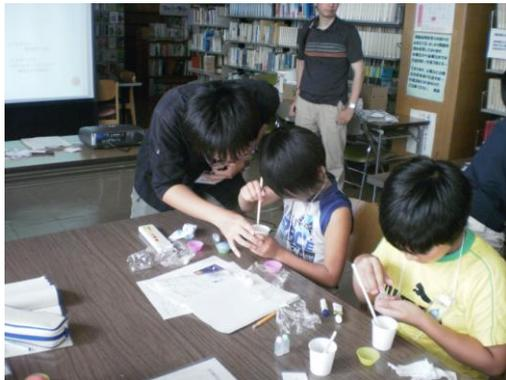
ポリウレタンの合成実験 ①。紙コップに2つの液体を入れてよくかき混ぜ、シリコンカップに移してしばらくすると、発泡して膨らんでくる。
